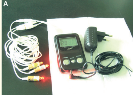
A GaAlAs 다이오드를 사용한 국산 저출력 레이저 장치 3개의 레이저 광원을 동시에 조사할 수 있다.
