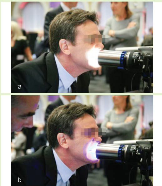
그림 9. QLF-D Biluminator의 백색광원(a)과 푸른 형광(b)을 이용해서 연속 촬영하는 모습
