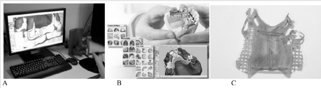
Fig. 2 디지털 국소의치 제작 시스템 (intellifit™). A: 디자인 소프트웨어인 Freeform과 입력 도구인 팬텀 햅틱 장치, B: '그루브 툴', '스무스 툴' 등 Freeform에서 지원하는 다양한 툴, C: 국소의치 프레임워크 주조를 위해 RP 생산된 희생패턴
