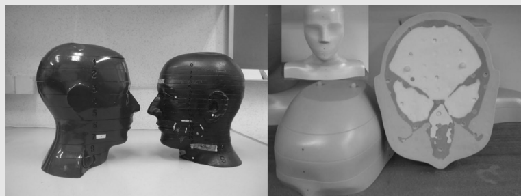
그림 1. 유효선량을 측정하기 위해 사용되는 인체 해부학적 구조와 장기를 모사한 RANDO® 팬텀
