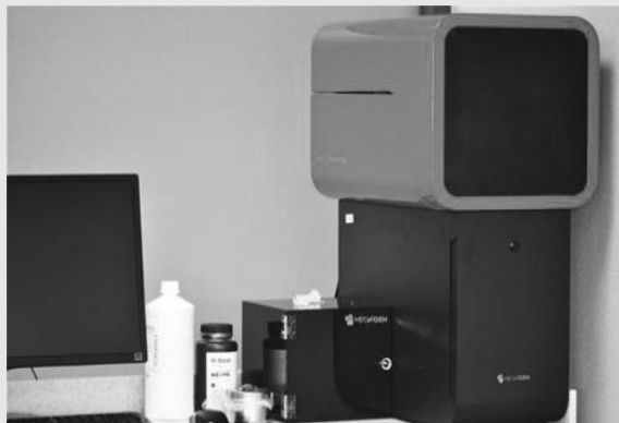
그림 21. DLP 방식의 3D 프린터 (Meg Printer; Megagen implant, Kyungbook, Korea)
