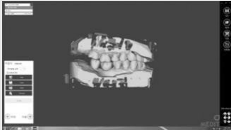
그림 6. Bite tray로 인상을 채득한 후 Exocad® 소프트웨어에서 불러와 virtual wax-up 시행
