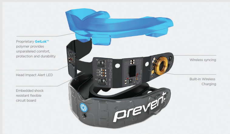
그림 10. 마우스가드 내부에 센서가 부착되어 있어 디지털 정보를 생성하는 상용 마우스가드
