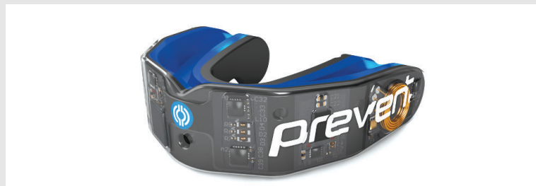
그림 11. 센서와 배터리가 내장된 Boil and Bite 마우스가드
