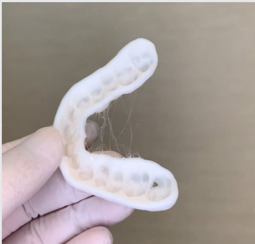
Fig. 21. 실처럼 생긴 부위는 열풍기를 이용한 후처리(post processing) 과정이 필요하다.
