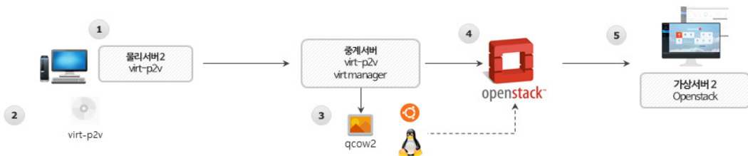
〈그림 21〉 virt-p2v 기반 전자기록 시스템 에뮬레이션 실험 절차
