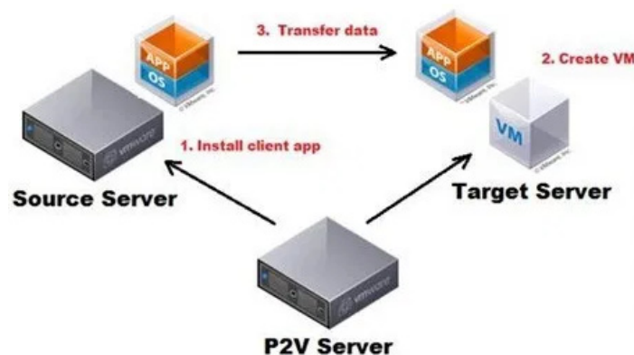
<그림 7> P2V 변환기 시스템 이전 과정
