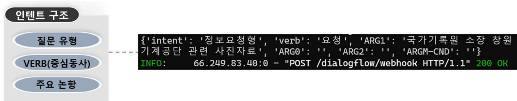
<그림 3> 인텐트 구조 개념도(좌)와 Webhook 기반 실제 처리 결과 예시(우)
