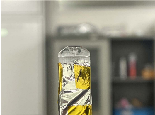
그림 12. 광학 그리스를 이용하여 PMMA 빛길잡이를 모듈에 부착한 사진.
